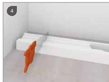
Odrežte polystyrénový blok na potrebnú dĺžku žľabu
