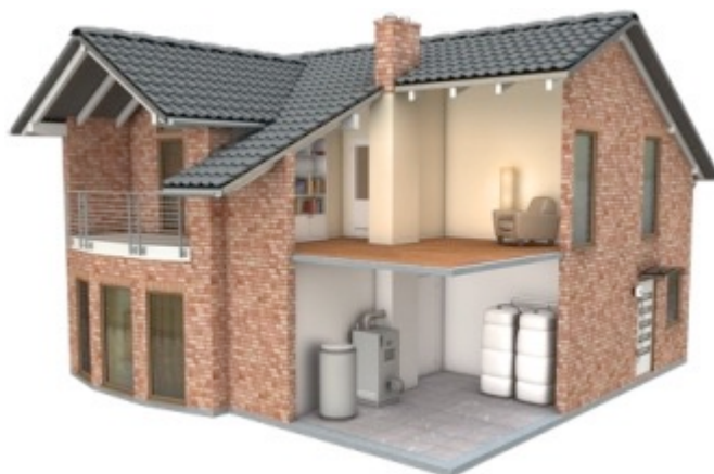
Olejový kotel včetně bojleru a zásobníků paliva v rodinném domě
